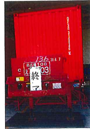
コンテナ作業終了の表示
