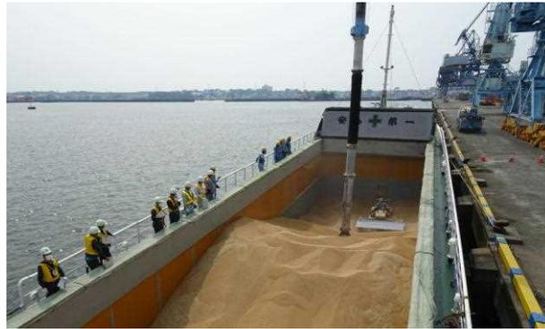
⇒アンローダーは、固定された位置から動かないようになっており、運転者はすぐに戻れる場所で別の仕事をし、デッキ上のリモコン操作には非常停止ボタンがついているので、緊急時にはデッキマンが非常停止ボタンを操作します。
